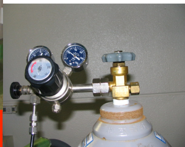
ヘリウムポンベのバルブ部分(使用時)
