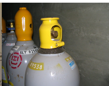
窒素ポンベのバルブ部分
