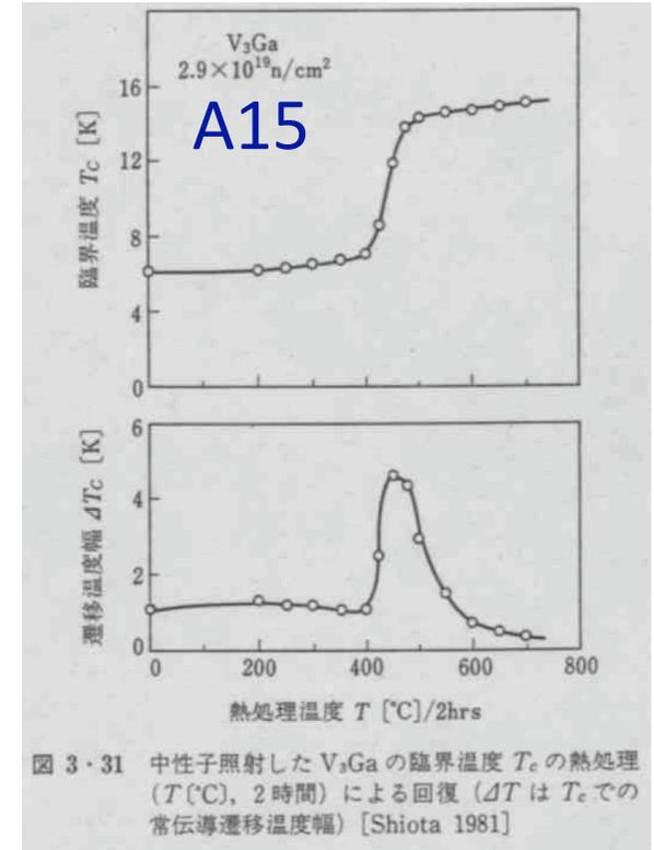
図 3・31 中性子照射した  $\text{V}_3\text{Ga}$  の臨界温度  $T_c$  の熱処理 ( $T$  (°C), 2 時間) による回復 ( $\Delta T$  は  $T_c$  での常伝導遷移温度幅) [Shiota 1981]
