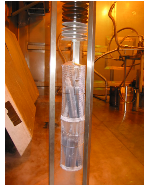
ガラスチューブ(真空)内に装 填された有機材料
